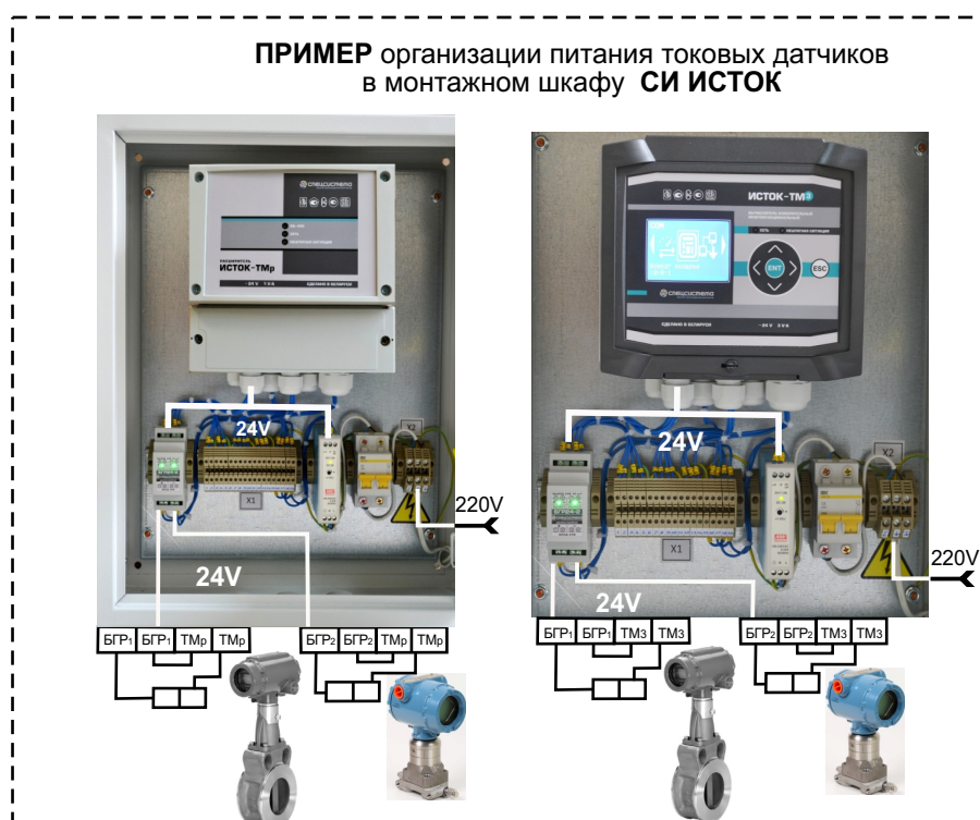
Рис 1 СИ ИСТОК-ПАР-07, пример внутренней компоновки монтажных шкафов вычислителя ИСТОК-ТМз и расширителя ИСТОК-ТМР
